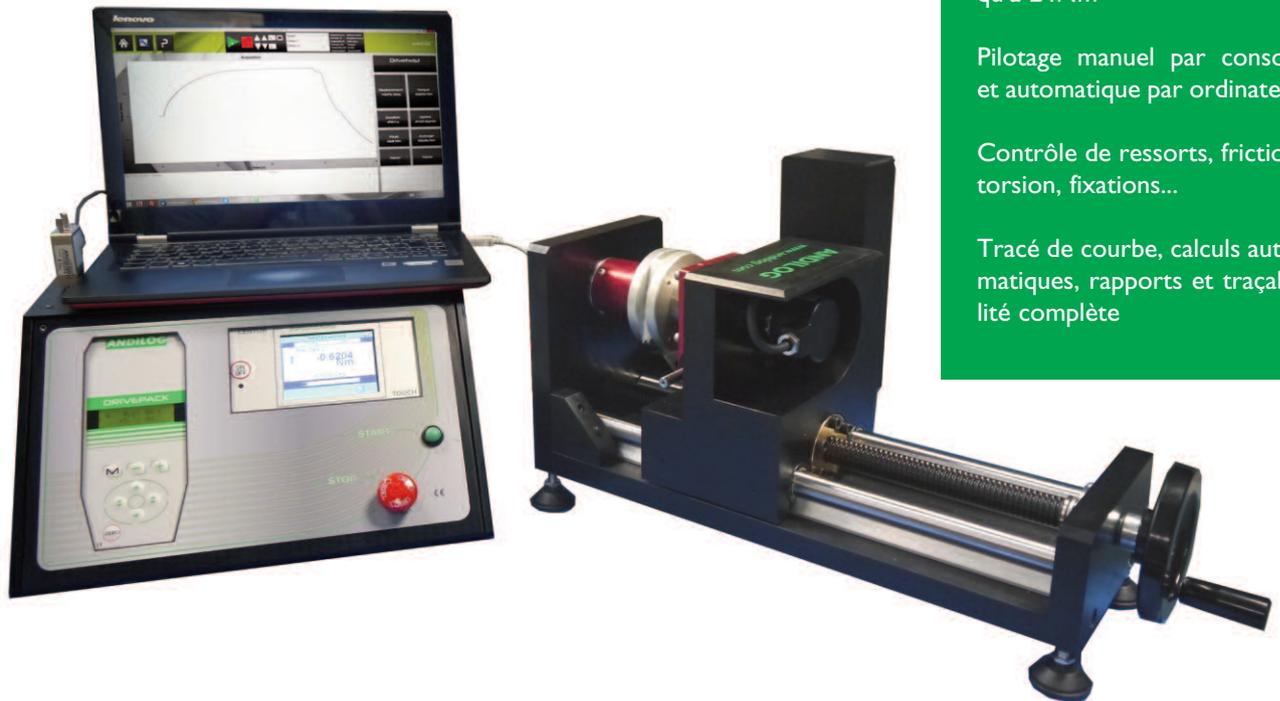
Pour réaliser une mesure de couple précise et répétitive, il est souvent nécessaire d'utiliser un banc de torsion. Le torsiomètre motorisé **DriveTwist** permet de réaliser ses mesures en s'affranchissant de l'influence de l'opérateur grâce à une rotation régulée à vitesse constante.
