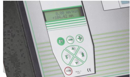
La commande de pilotage manuel permet de déplacer la traverse de la machine d'essai pour se mettre en position avant les mesures ou pour ajuster les premiers essais.
