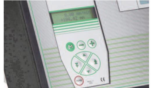
La commande de pilotage manuel permet de déplacer la traverse de la machine d'essai pour se mettre en position avant les mesures ou pour ajuster les premiers essais.
