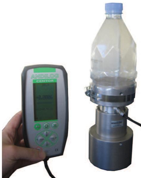
Bouteille instrumentée pour la mesure du couple de serrage des bouchonneuses. Le support mécanique intègre un capteur de couple et a été conçu sur mesure pour s'adapter au format des bouteilles d'eau minérales.
