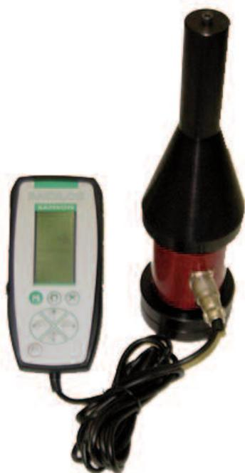
Bouteille instrumentée pour la mesure de force des bouchonneuses de bouteilles de champagne. La mécanique conçue à façon intègre un capteur de force de 10 kN.
