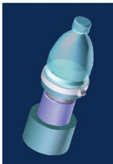
Nos bouteilles instrumentées sont conçus par notre bureau d'étude pour répondre de façon précise à votre besoin. Les éléments mécaniques doivent être au plus près de la forme et des dimensions de la bouteille originale pour minimiser les erreurs de mesure. Nous usinons la bouteille dans des matériaux conçus pour le milieu agroalimentaire (projection de liquide, résistance, nettoyage...)
